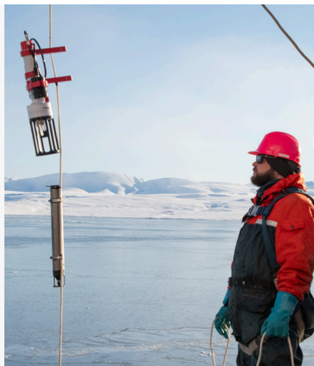
Déploiement de lignes de mouillage comprenant divers instruments océanographiques.
