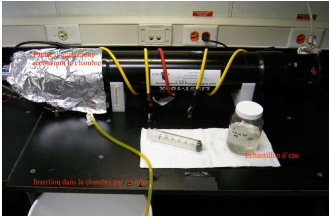
Figure 11 : Mise en place de l'instrument LISST-100X. © Anne-Sophie Fabris
