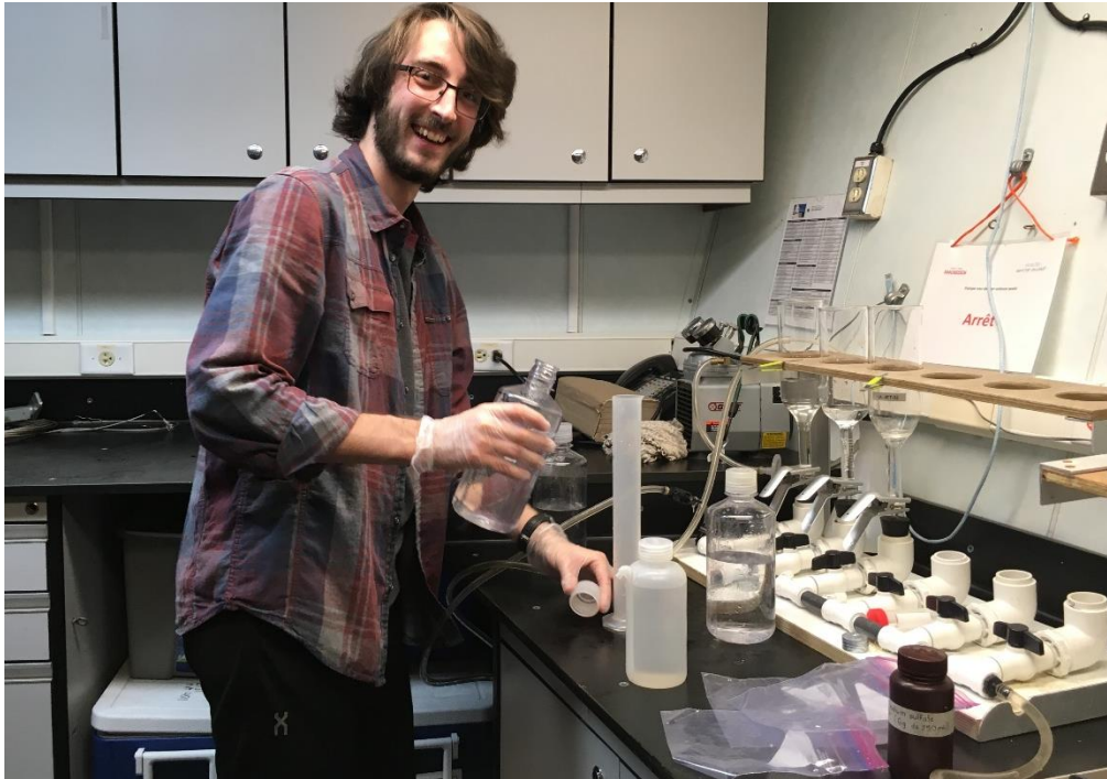
Figure 4 : Système de filtration pour sédiment. © Gabrièle Deslongchamps
