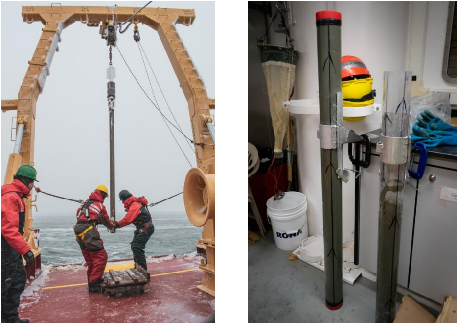
Figure 13. Récupération d'un carottier à gravité (à gauche) et manipulation des carottes dans le laboratoire de géologie du navire (à droite) ©Jean-Carlos Montero-Serrano.
