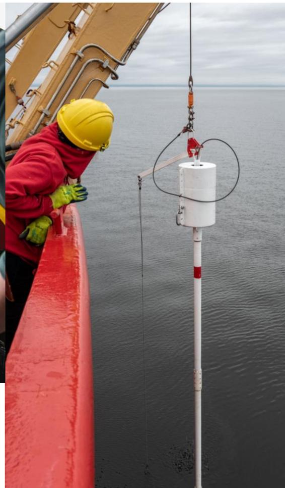
Une carotteuse à piston permet un échantillonnage des couches du sous-sol marin sur plusieurs mètres
