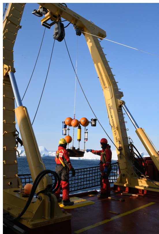
Une mouillage en cours de déploiement près de l'entrée de la mer de Lincoln.
